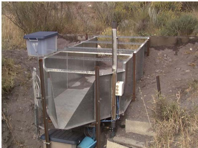
Fig 12.- Aforador tipo H de 60 cm de altura (capacidad 340 L s<sup>-1</sup>) en la cuenca principal de Rambla Honda (4,6 ha).
