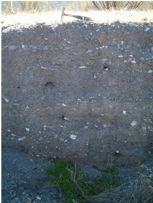
Fig 6.- Típico perfil de suelo, de tipo AC, en la parte baja de un cono aluvial en Rambla Honda. Se observa la típica estratificación en lentejones de arena y grava y un desarrollo edáfico incipiente (horizonte Ap).
